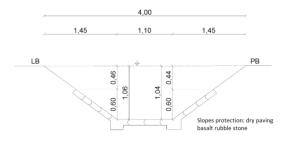
Fig. 1. Cross-section profile of the Pryský brook (values in m)
